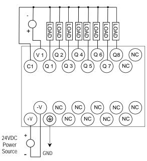
Wiring Diagram, IC200UE0016
