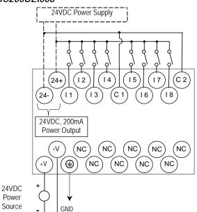
Wiring Diagram, IC200UEI016
